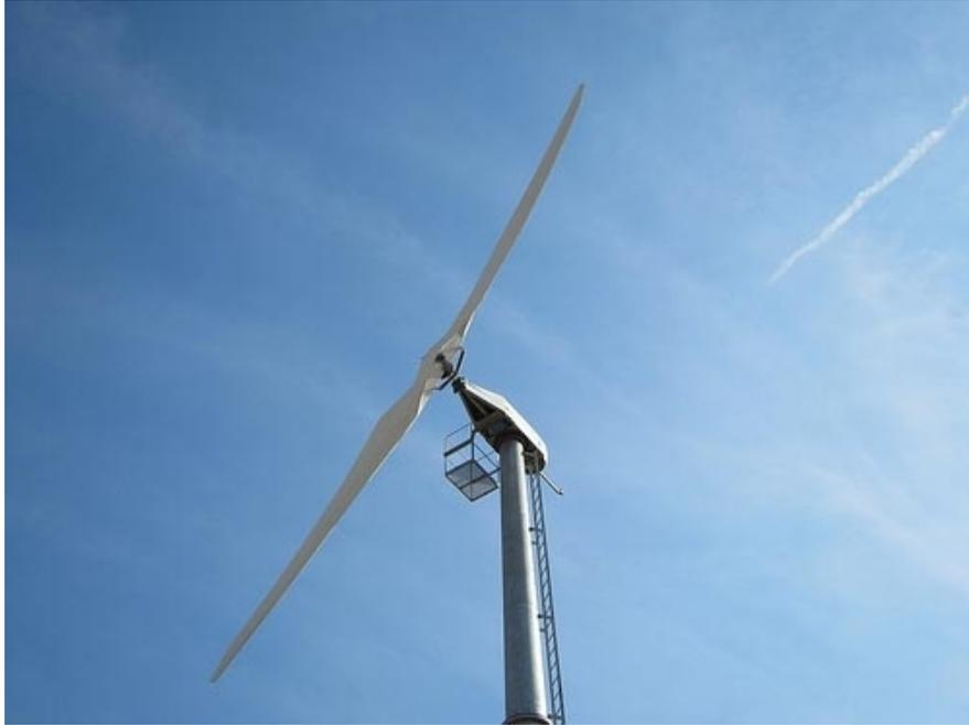
2叶片下风式水平轴风力发电机
